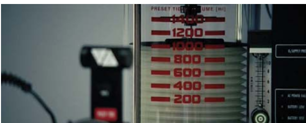
Foto 6. Regulación de la función pulmonar mediante un aparato que controla el número de respiraciones por minuto y el volumen de cada una de ellas.
